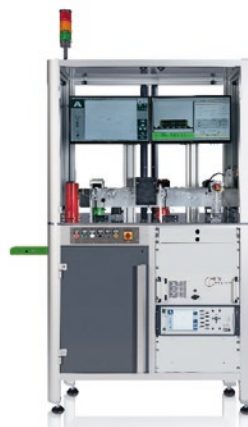
HDSグループ社の生産ライン用テストセル「Merkur」は、ピンやスリーブなどのヘッドレス接続部品の形状および微細組織構造の検査に使用されます。FOERSTERの統合型MAGNATEST Dを使用
