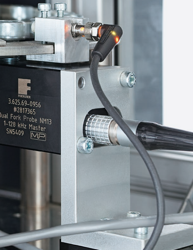
HDSグループ社の生産ライン用テストセル「Merkur」は、ピンやスリーブなどのヘッドレス接続部品の形状および微細組織構造の検査に使用されます。FOERSTERの統合型MAGNATEST Dを使用
