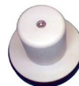
図3: シャフト検査用の円形コイル(左)と、CVジョイントの固定アウターレース検査用に形状を適合させたフィットプローブ(右)
